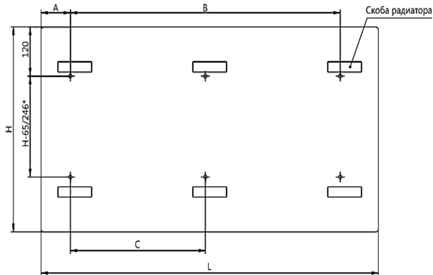
**Примечание:** Размеры A перед дробной чертой указаны для варианта установки кронштейнов малой полкой к стене
